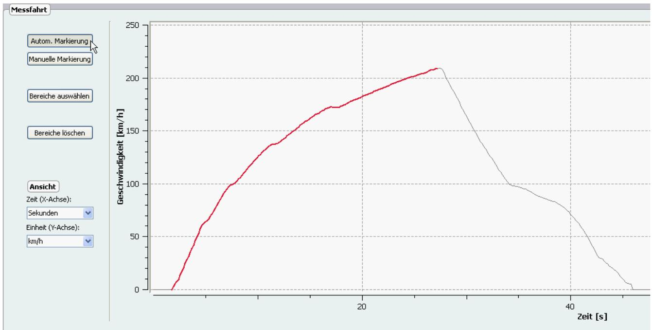
Sie können Beschleunigungen aus dem Stand entweder in Bezug auf eine bestimmte Endgeschwindigkeit („Null bis...“) oder in Bezug auf die fixe Messlänge von ¼ Meile auswerten.
