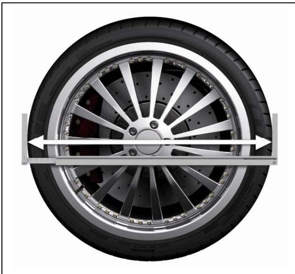
Die Messung des Raddurchmessers wird in horizontaler Lage vorgenommen, da hier in jedem Fall der erforderliche Raum zwischen Rad und Radkasten vorhanden ist.
