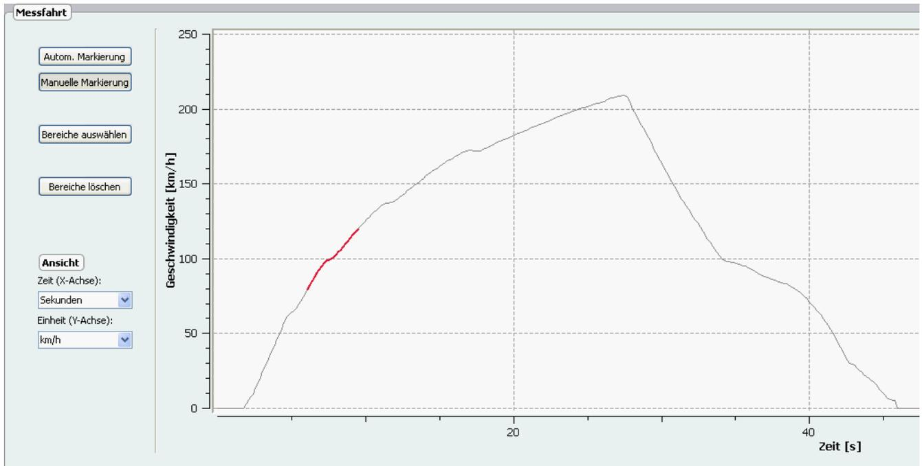
(hier wurde der Bereich von 80 – 120 km/h ausgewählt. In der Beschleunigungslinie kann man sehr schön den „Schaltknick“ erkennen, welcher viermal in die nächste Getriebestufe führt)
