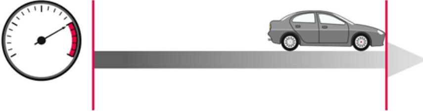
Bei Schaltgetriebe auskuppeln, bei Automatikgetriebe in N und rollen lassen. Ist das bei älteren Automatikgetriebe nicht möglich, darf in diesem Fall in die höchste Fahrstufe geschaltet werden.
